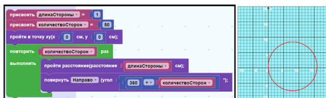
Рис. 3. Пример программы черчения окружности. Исполнение программы черчения круга
