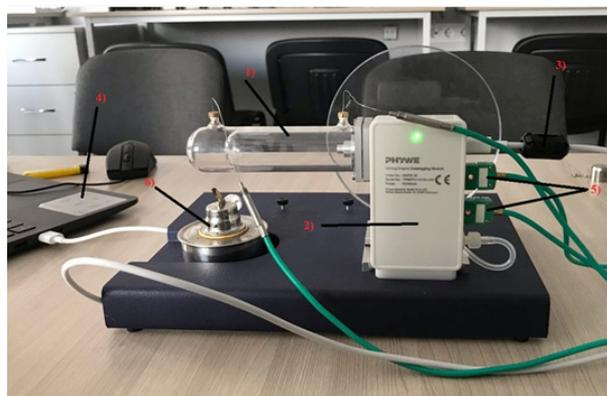
Рис. 1. Экспериментальная установка «Двигатель Стирлинга»
